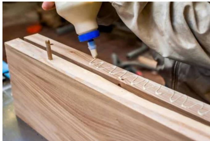
Abbildung 5: Geklebte Holzverbindungen; Quelle: [28]
