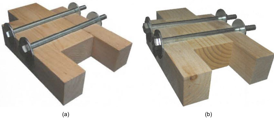
Abbildung 7: (a) Bolzen und (b) Passbolzen; Quelle: [32]
